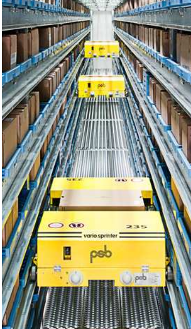
En point de mire : navette vario.sprinter psb pour un contrôle de capacité efficace en énergie dans la zone de stockage (Image: psb intralogistics GmbH)
