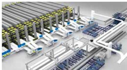
Ziehetechnik. Depalettier- und Palettier-Roboter dienen zum automatischen Kartonbe- und -entladen auf Ablare. Innerhalb der Schnelldreherzone sind Fördersysteme für Kunststoffablare und Drehstapelbehälter (DSB) sowie Fördersysteme für Gitterboxen und Paletten im Einsatz.
