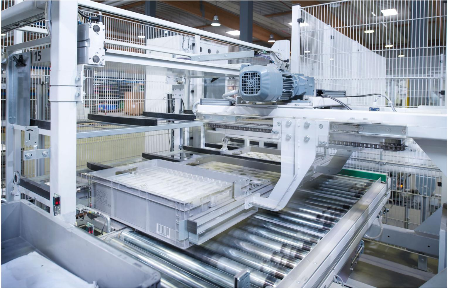
Im Kommissionierbahnhof werden die Routenzugwagen vollautomatisch beladen
