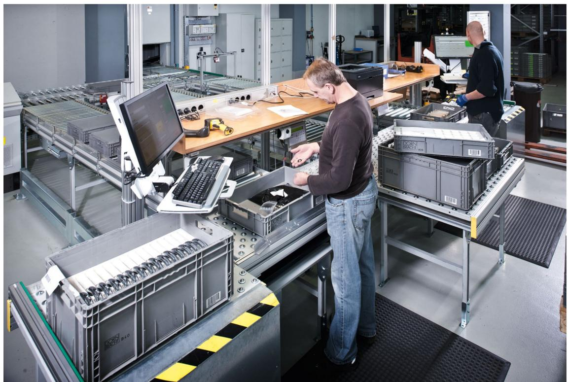
Im Rahmen des Projektes »Aufbau einer Montageversorgungslogistik für die Serienfertigung« werden in Eigenfertigung erzeugte Oberflächenteile und Zukaufartikel zentral eingelagert. Dies erfolgt in einem mehrgassigen AKL mit über 26.000 Lagerplätzen.
