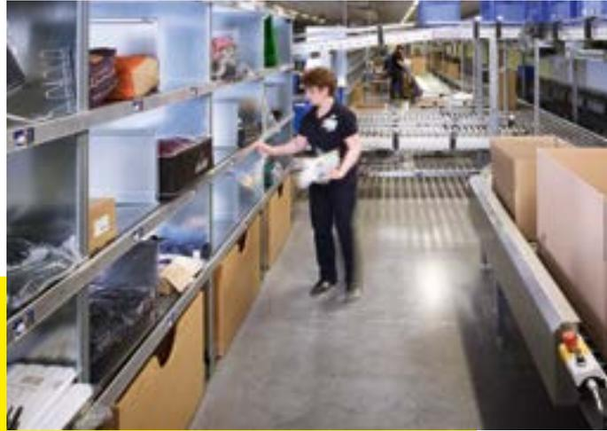
Im Kommissionierbahnhof wird über ein Sortierregal von der Sammel-Kommissionierung zu einer auftragsbezogenen Kommissionierung umsortiert. Der fertige Auftrag liegt im Sortierfach und löst den auftragsgerecht ...
