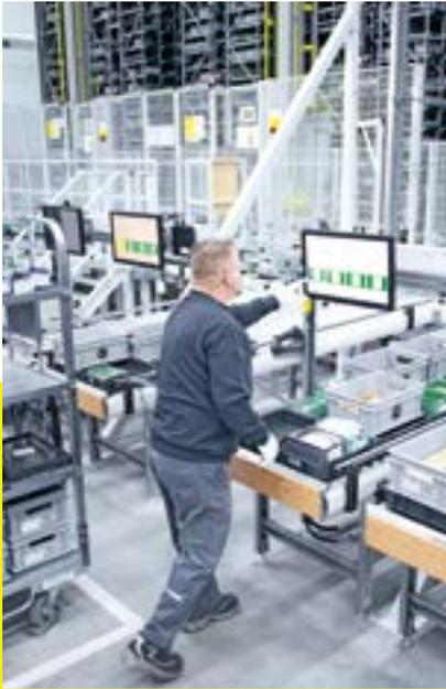
Die kommissionierten Behälter werden entsprechend der Ziele in Fertigung und Montage in der richtigen Entnahme-Reihenfolge auf Sorterbahnen verteilt.
