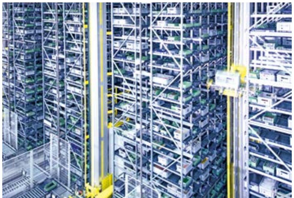
Im Laufe des Fertigungsprozesses werden immer wieder Kleinbehälter von den im AKL gelagerten Tablaren entnommen. Daher identifiziert das WMS von psb automatisch Tablare mit einem Füllgrad unter 50 Prozent (parametrisierbar) und fördert sie zum Wareneingang, wo sie wieder aufgefüllt werden. Somit ist permanent eine hohe Lagerdichte des AKL gesichert.
