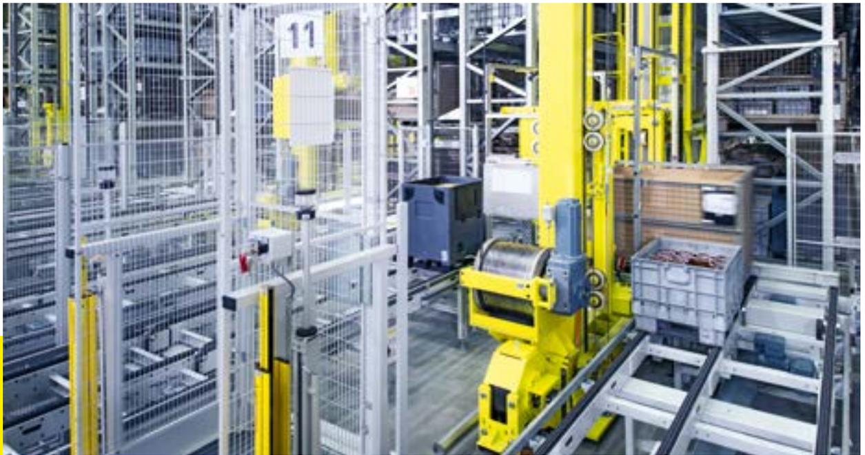
Im HRL kommen fünf RBG des Typs *maxloader* zum Einsatz, deren Lastaufnahmemittel für doppelte Lagerung ausgelegt sind.
