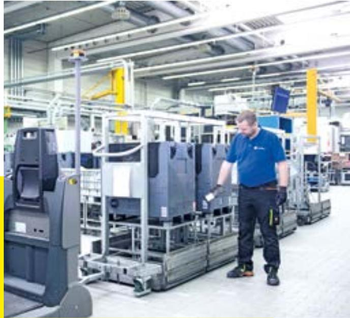
Die Routenzüge werden von einem von psb speziell für MR entwickelten und in das *selektron* WMS integrierten Leitsystem gesteuert.
