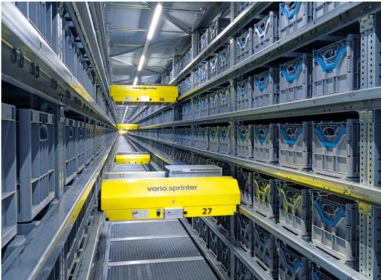
↑ Shuttle-Lager mit 150.000 Stellplätzen und einer direkten Fördertechnikanbindung auf halber Lagerhöhe
