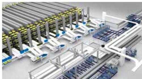
technique de traction. Des robots de palettisation et dépalettisation sont utilisés pour le chargement/déchargement automatique des cartons sur les plateaux: dans la zone à rotation rapide sont utilisés des systèmes de convoyage pour plateaux plastiques et bacs gerbables emboîtables et les systèmes de convoyage pour des caisse-palettes grillagées et palettes.
