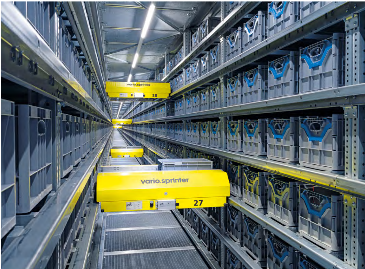
↑ Magasin à navettes offrant 150.000 emplacements de stockage et raccordé directement au système de convoyage à mi-hauteur du magasin.
